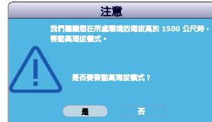
當**高海拔模式**運作時，為了達到降低設備的溫度並提高效能而必須提高風扇的轉速，也因此會產生較高分貝的運作噪音。
