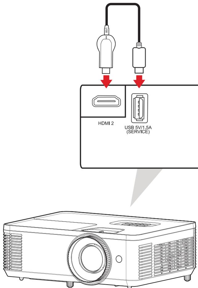
**NOTA:** USB tipo A supporta l'uscita di alimentazione 5 V/1,5 A per la ricarica del dongle HDMI.
