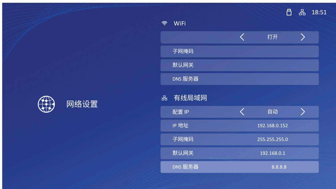
3. 可以自动或手动配置 IP。选择**手动**将允许访问 **IP地址**、**子网掩码**、**默认网关**和 **DNS服务器**。
