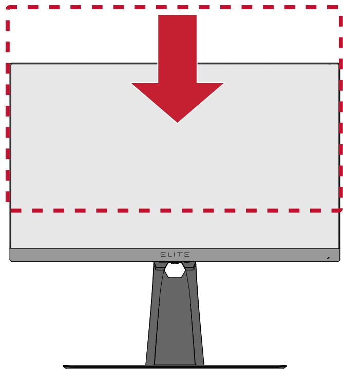
注：调整时，用两只手握住显示器侧面，沿调整轨道方向用力向下压。
