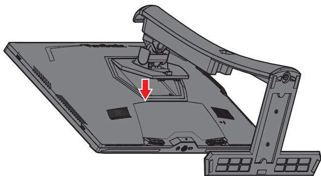
**5.** 将安装支架连接到显示器后部的 VESA 安装孔。然后用四枚螺丝 (M4 x 10 mm) 固定安装支架。
