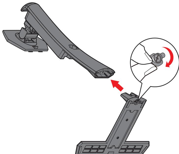
**4. 将底座上方的卡钩与显示器底座安装槽对齐并滑入安装槽中，如下图所示：**
