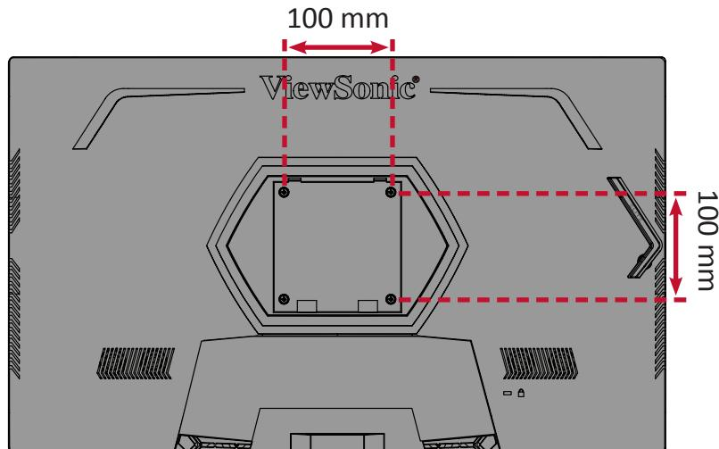
**6.** 按照壁装套件随附的说明书将显示器安装在墙壁上。
