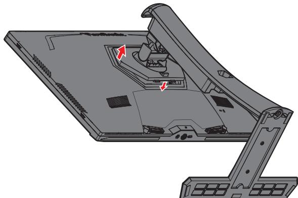
4. 轻轻地向下拉动卡钩，使其脱离安装槽，然后拆下底座。
