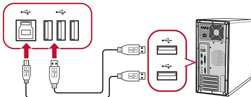
**注：**紧邻 USB B 型端口的 USB A 型端口支持 5V 2.1A 快速充电。另外两个 USB A 型端口支持 5V 0.9A 充电。
