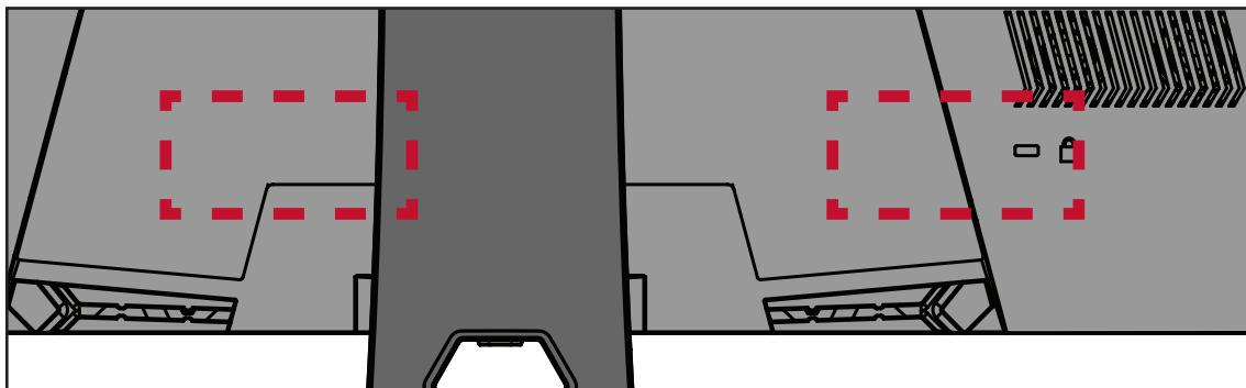
显示器背面的 I/O 端口下有两个鼠标线固定器，可用于防止线缆被拖拽，并可对鼠标使用进行个性化设置。
