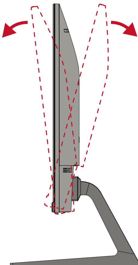
**ПРИМЕЧАНИЕ.** В ходе регулировки одной рукой поддерживайте подставку, а другой наклоняйте монитор вперед или назад.
