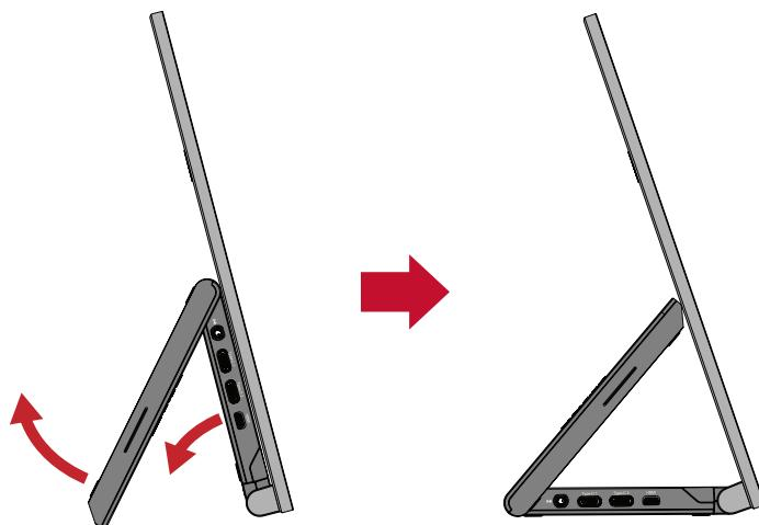
**ЗАБЕЛЕЖКА:** При регулиране поддържайте здраво с една ръка докато наклонявате монитора напред или назад с другата ръка.
