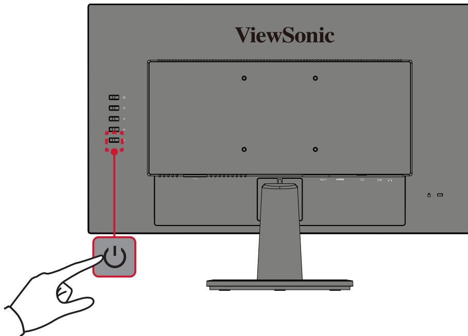
**NAPOMENA:** Monitor će i dalje trošiti određenu struju sve dok je kabl za napajanje priključen u strujnu utičnicu. Ako se monitor ne koristi duži vremenski period, isključite utikač za napajanje iz strujne utičnice.
