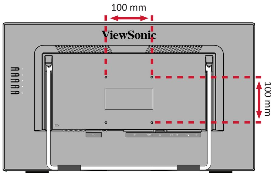
5. 按照壁装套件随附的说明书将显示器安装在墙壁上。
