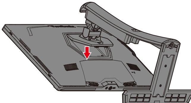
**5.** Выровняйте монтажный кронштейн с крепежными отверстиями VESA на задней панели монитора. Зафиксируйте его с помощью четырех (4) винтов (M4 x 10 мм).
