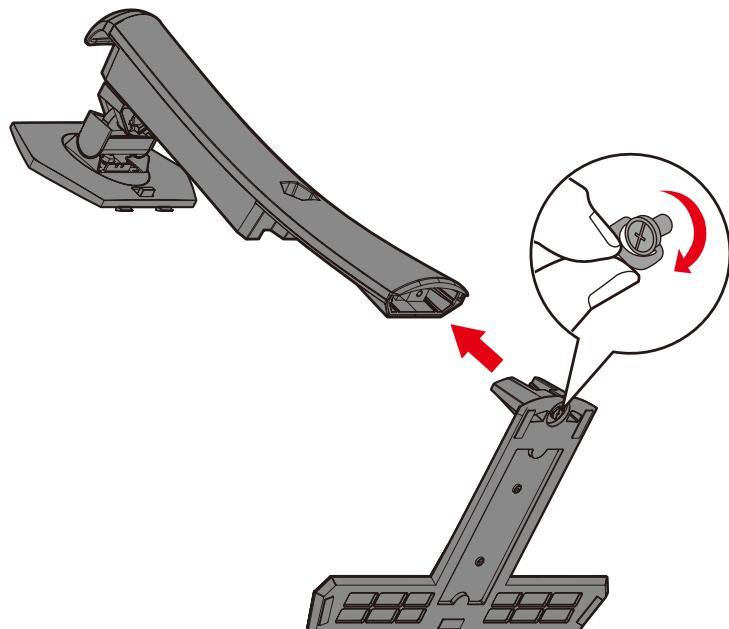
**4. Выровняйте и вставьте верхние фиксаторы подставки монитора в разъемы для установки, как показано на рисунке ниже:**
