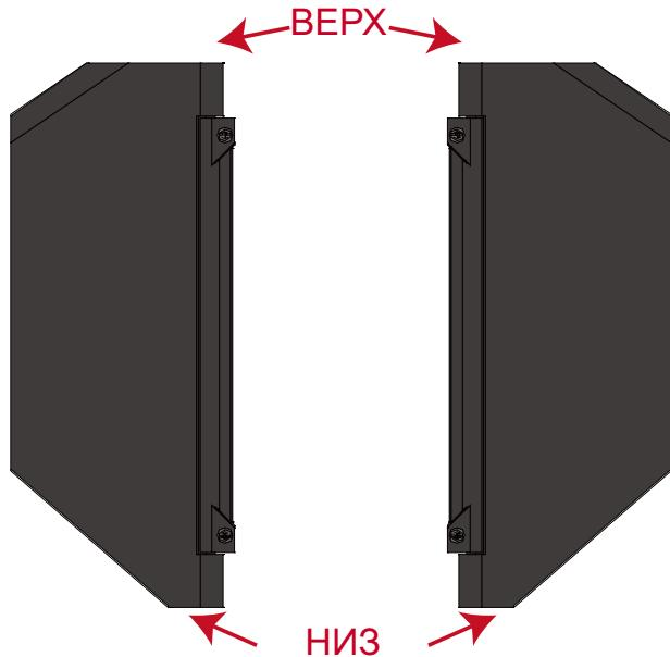
3. Совместите все винты на детали козырька Elite Hood с винтовыми отверстиями на боковой панели монитора.
