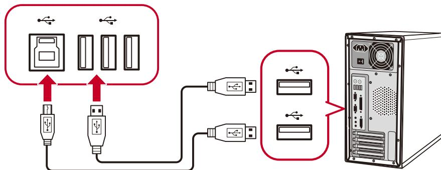
**ПРИМЕЧАНИЕ.** Порт USB тип А рядом с портом USB тип В может поддерживать быструю зарядку 5 В 2,1 А. Два других порта USB тип А могут поддерживать зарядку 5 В 0,9 А.
