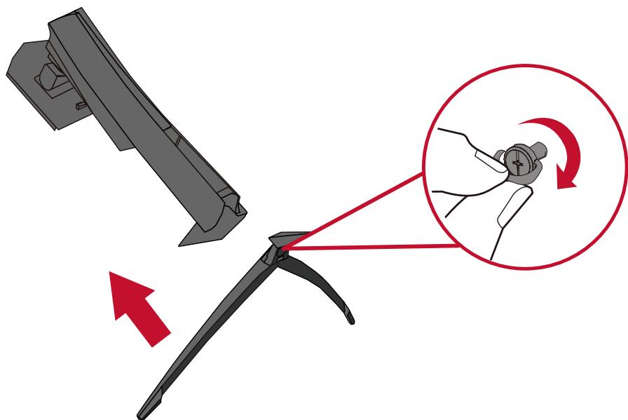
**4.** Выровняйте и вставьте верхние фиксаторы подставки монитора в разъемы для установки, как показано на рисунке ниже:
