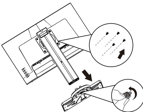
4. Συνδέστε τον βραχίονα τοποθέτησης στις οπές στερέωσης VESA στο πίσω μέρος της συσκευής. Στη συνέχεια ασφαλίστε τον με τις τέσσερις (4) βίδες (M4 x 10 mm).
