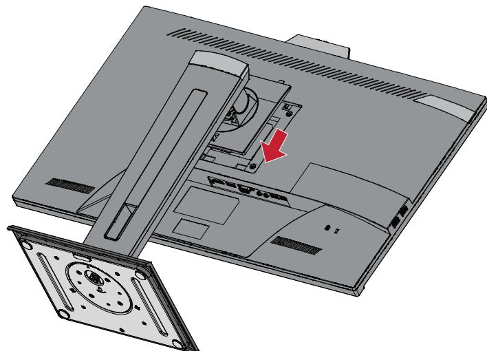
**5.** Συνδέστε τον βραχίονα τοποθέτησης στις οπές στερέωσης VESA στο πίσω μέρος της συσκευής. Στη συνέχεια ασφαλίστε τον με τις τέσσερις (4) βίδες (M4 x 10 mm).
