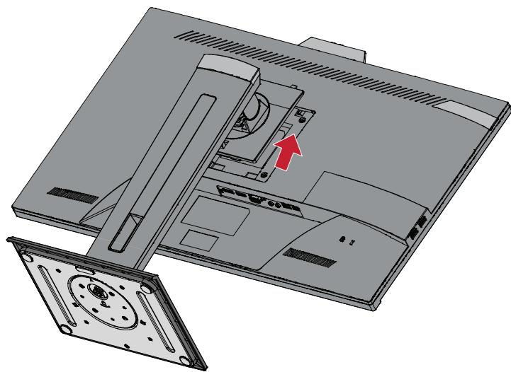
**BEMÆRK:** Sørg for, at stativet sidder fast, og at frigivelsestappen klikkes på plads.
