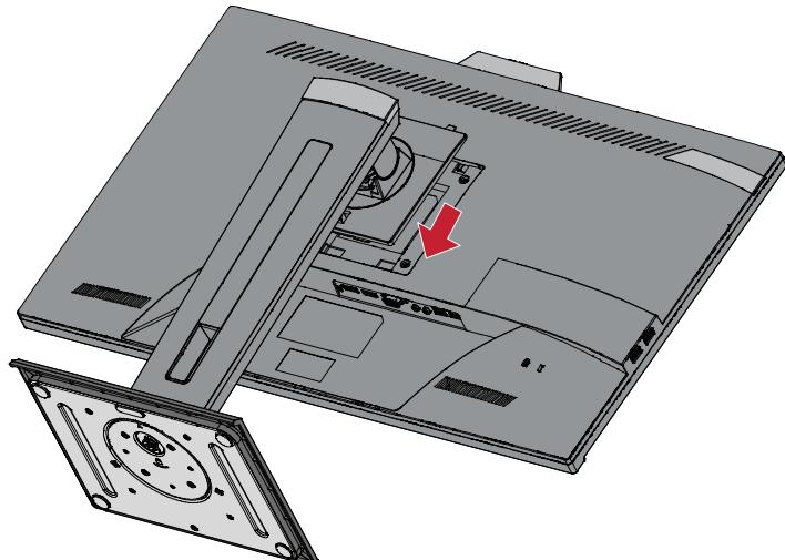
**5.** Skru ophængsbeslaget fast i hullerne VESA-ophænget bag på skærmen. Spænd det fast med fire (4) skruer (M4 x 10 mm).
