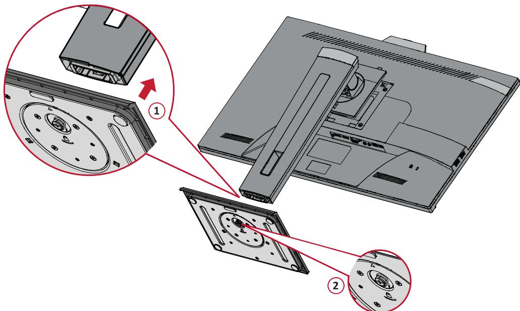
**4.** Hold de øvre kroge mod monteringsrillerne på skærmstativet, og tryk dem ind i, som vist på billedet nedenfor:
