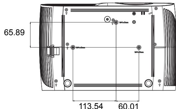
吊顶安装螺丝：
