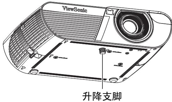
此投影机配备升降支脚，用于调整图像高度。如要升高或降低图像，可以转动升降支脚以微调高度。
