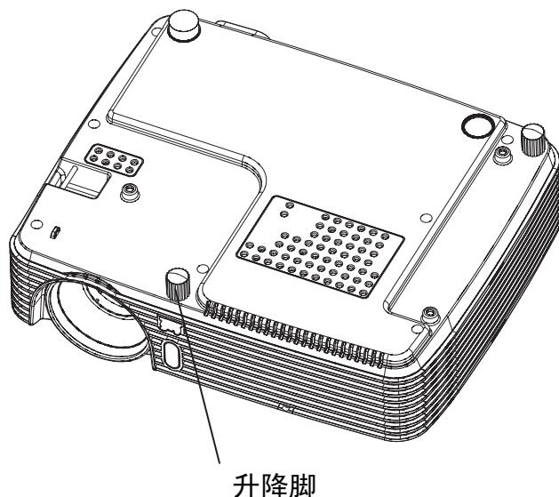
此投影机配备升降脚，用于调整图像高度。升高或降低图像，转动升降脚以微调高度。
