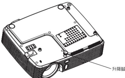
此投影機配備升降腳，可調整影像高度。升高或降低影像，可轉動傾斜調整腳，對高度進行微調。
