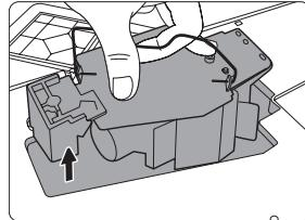
7. 将新灯泡插入灯泡舱，确保在投影机中安装到位。
