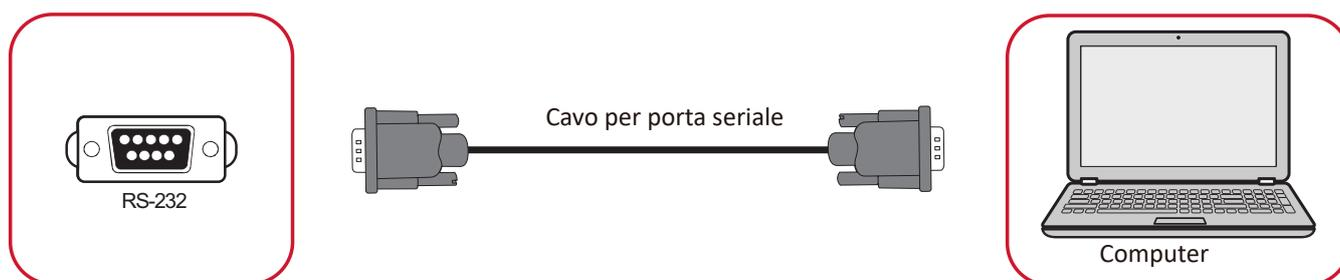
Quando si utilizza un cavo per porta seriale RS-232 per collegare il display a un computer esterno, alcune funzioni possono essere controllate in remoto dal PC, tra cui accensione/spegnimento, regolazione del volume, selezione ingresso, luminosità e altro.
