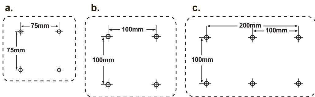
5. Pričvrstite monitor za zid, prateći uputstva u kompletu za montiranje na zid.
