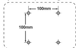
**Korak 6.** Pritrdite LCD zaslon na steno, po navodilih, ki jih dobite poleg opreme za stensko namestitev.
