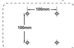
**Krok 6.** LCD displej namontujte na stenu, a to podľa pokynov pre montážnu súpravu pre osadenie na stenu.
