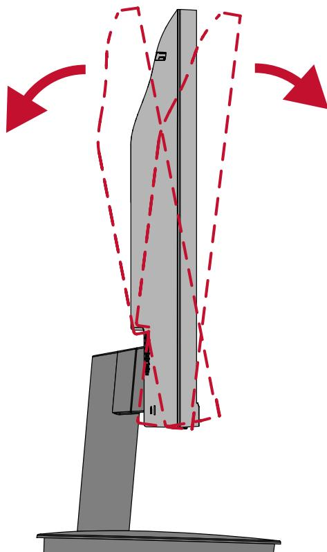
**注意事項:** 調整するときは、一方の手でスタンドをしっかりと支え、他方の手でディスプレイを前方または後方に傾きを変えてください。
