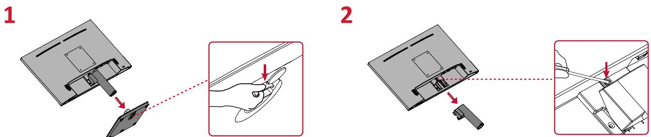
4. 取り付けブラケットを、本体背面にある VESA 取り付け口に取り付けます。次に4箇所を、4本のネジ(M4 × 10mm)で固定します。
