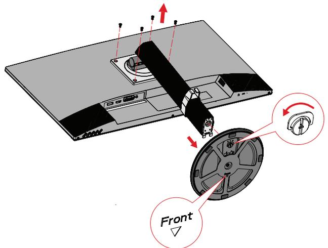
4. Fissare la staffa di montaggio ai fori di montaggio VESA sul retro del dispositivo. Quindi fissarlo con le quattro (4) viti (M4 x 10 mm).
