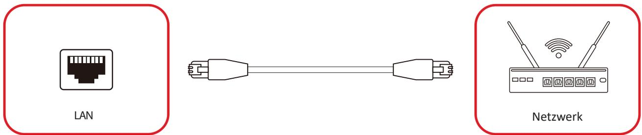
Zur Verbindung mit einem Netzwerk schließen Sie ein Ethernet-Kabel an Ihr Netzwerk an und verbinden dann das andere Ende mit dem **LAN**-Anschluss des Displays.
