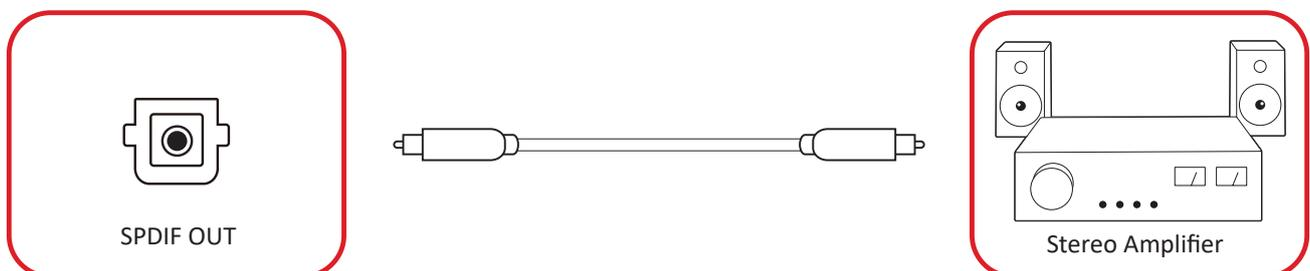
**Hinweis:** Der Anschluss **SPDIF Out** ist durch Entfernen der Abdeckung der Systemsteuerungsbox zugänglich.
