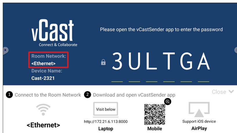
2. Besuchen Sie am Client-Gerät die Adresse, die am Display angezeigt ist, laden Sie die Anwendung vCastSender herunter und installieren Sie sie.
