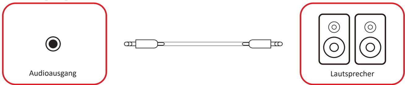
Damit Audio vom Display über einen externen Lautsprecher wiedergegeben wird, verbinden Sie ein Ende eines Audiokabels mit dem externen Lautsprecher und das andere Ende mit dem Anschluss **Audio Out** des Displays.
