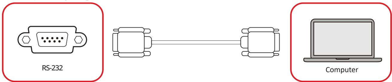
Wenn Sie das Display über ein serielles RS-232-Kabel mit einem externen Computer oder Steuersystem verbinden, können bestimmte Funktionen ferngesteuert werden, wie z. B. Ein-/Abschaltung, Lautstärkeanpassung, Eingangswahl, Helligkeit und mehr.
