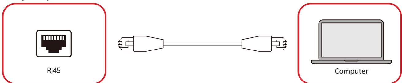
Wenn Sie das Display über ein Ethernet-Kabel mit einem externen Computer oder Steuersystem verbinden, können bestimmte Funktionen ferngesteuert werden, wie z. B. Ein-/Abschaltung, Lautstärkeanpassung, Eingangswahl, Helligkeit und mehr.
