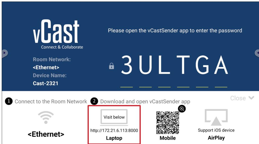
1. Stellen Sie sicher, dass das Client-Gerät (z. B. Laptop) mit demselben Netzwerk wie das Display verbunden ist.
