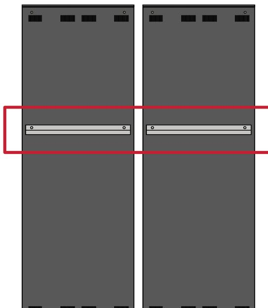
2. Осторожно поднимите корпус и поставьте на *напольную стойку*, прикрепив монтажный кронштейн к опоре на *верхней поперечной балке*. Нижняя часть корпуса будет опираться на *нижнюю поперечную балку*.
