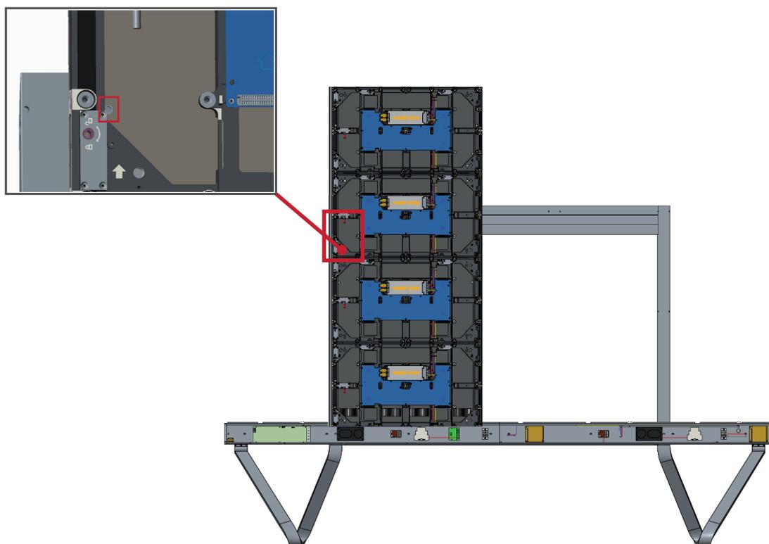
4. Нажмите на стопорные болты и зафиксируйте все крючки шестигранным инструментом, чтобы надежно соединить все корпуса между собой.
