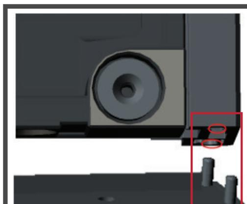
3. Затем прикрепите *системную коробку управления* к корпусам с помощью 16 входящих в комплект винтов (M6x16 мм).
