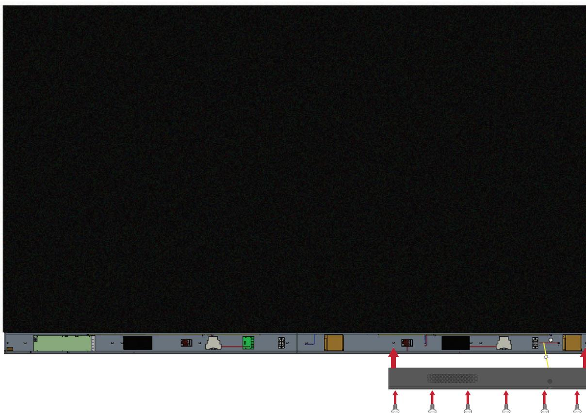
3. Повторите вышеуказанные действия для *средней* и *левой крышки*. После того, как все *крышки* будут закреплены, ваш светодиодный дисплей готов к работе.
