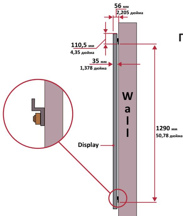
**ПРИМЕЧАНИЕ.** Альтернативно можно установить верхние *кронштейны для настенного монтажа*, повесить экран, а затем установить нижние *кронштейны для настенного монтажа* для более точного прилегания.
