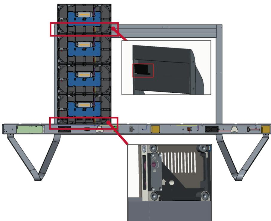
3. Прикрепите корпус к опоре входящими в комплект винтами (M6x10 мм).
