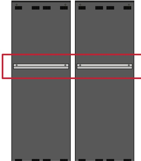
2. Heben Sie ein *Gehäuse* vorsichtig auf den *Bodenständer*, sichern sie die *Halteung* im Stützkanal der *oberen Kreuzstrebe*. Die Unterseite des *Gehäuses* ruht auf der *unteren Kreuzstrebe*.
