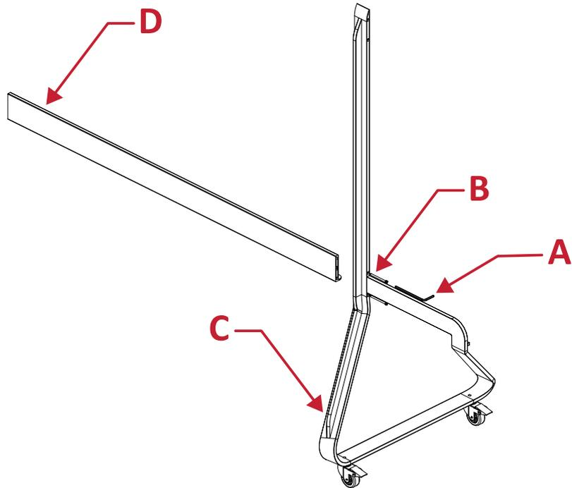
2. Verbinden Sie die *rechte Stütze* über zwei (2) Schrauben (M6 x 80 mm) mit der *unteren Kreuzstrebe*.
