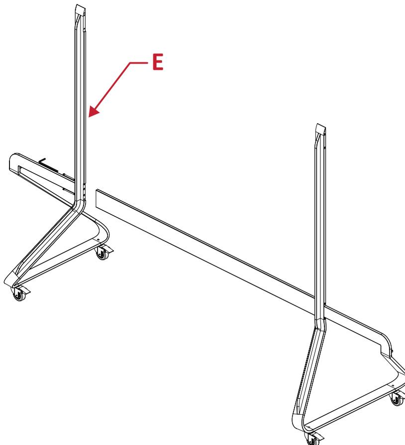
3. Verbinden Sie die *obere Kreuzstrebe* über vier (4) Schrauben (M6 x 80 mm) mit der *linken* und *rechten Stütze*.
