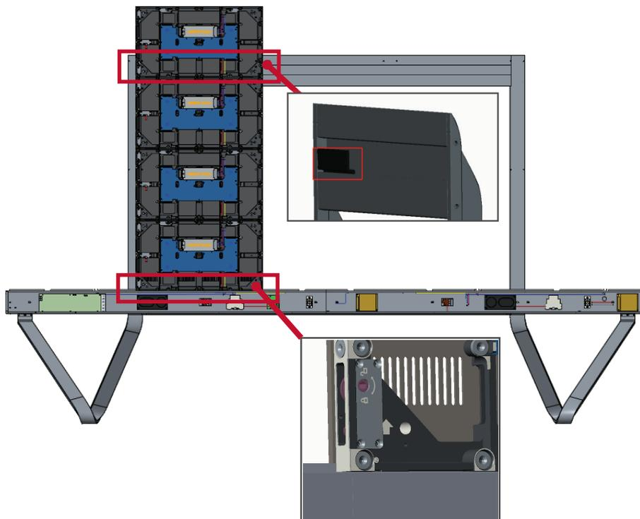
3. Sichern Sie das *Gehäuse* mit den mitgelieferten Schrauben (M6 x 10 mm) an der *Stütze*.
