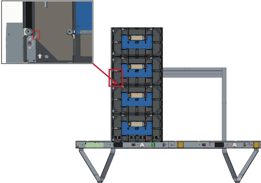
4. Drücken Sie jede *Sperrschraube* und verriegeln Sie jeden *Haken* mit dem Sechskantwerkzeug, damit die Schränke zuverlässig miteinander verbunden sind.
