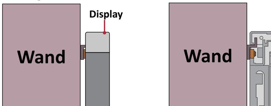
4. Drücken Sie jede *Sperrschraube* und verriegeln Sie jeden *Haken* mit dem Sechskantwerkzeug, damit die Schränke zuverlässig miteinander verbunden sind.
